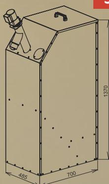
**AZPD 300** – un ensemble silo de 300 l avec des convoyeurs DRA25 – 1,3 m qui convient aux petites chaufferies. Il peut être placé à côté de la chaudière pour s'adapter aux espaces plus petits. Le silo de 300 litres contient 195 kg de granulés, ce qui fournit environ 880 kWh (13 sacs).
