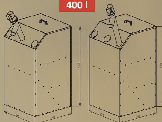
**AZPD / AZPU 400** – un ensemble silo de 400 litres avec convoyeur DRA25 – 1,3 m qui convient aux petites chaufferies. Il peut être placé à côté de la chaudière pour s'adapter à des espaces plus petits. Le silo de 400 litres contient 260 kg de granulés, ce qui fournit environ 1170 kWh (17 sacs).
