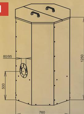
Le silo de **taille moyenne** convient à tous les chaudières conçues pour des petites chaufferies où les plus grands silos ne peuvent pas être utilisés. Il contient 325 kg de granulés, ce qui correspond environ à 1463 kWh (21 sacs).
