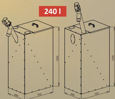
**AZPD / AZPU 240** – un ensemble silos de 240 litres avec convoyeur DRA25 – 1,3/1,7 m qui convient aux petites chaufferies. Il peut être placé à côté de la chaudière pour s'adapter aux espaces restreints. Le silo de 240 litres contient 156 kg de granulés, ce qui correspond à environ 700 kWh (10 sacs).
