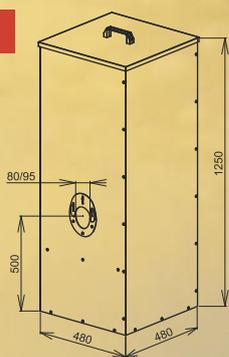
Le **plus petit** silo convient à tous les types de chaudières conçues pour des chaufferies plus petites où des silos plus grands ne peuvent pas être utilisés. Il contient 163 kg de granulés, ce qui équivaut à environ 730 kWh (10 sacs).
